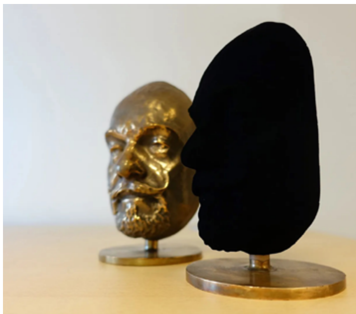
3. Przykład na to, jak wygląda obiekt pokryty substancją Vantablack
